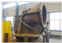
产品介绍: 出口沙特阿拉伯项目, 1800VZNM双相不锈钢立式轴流泵 出水弯管 部件
