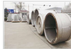
产品介绍: 福建鸿山热电厂项目, 2400VZNM双相不锈钢立式轴流泵 部件
